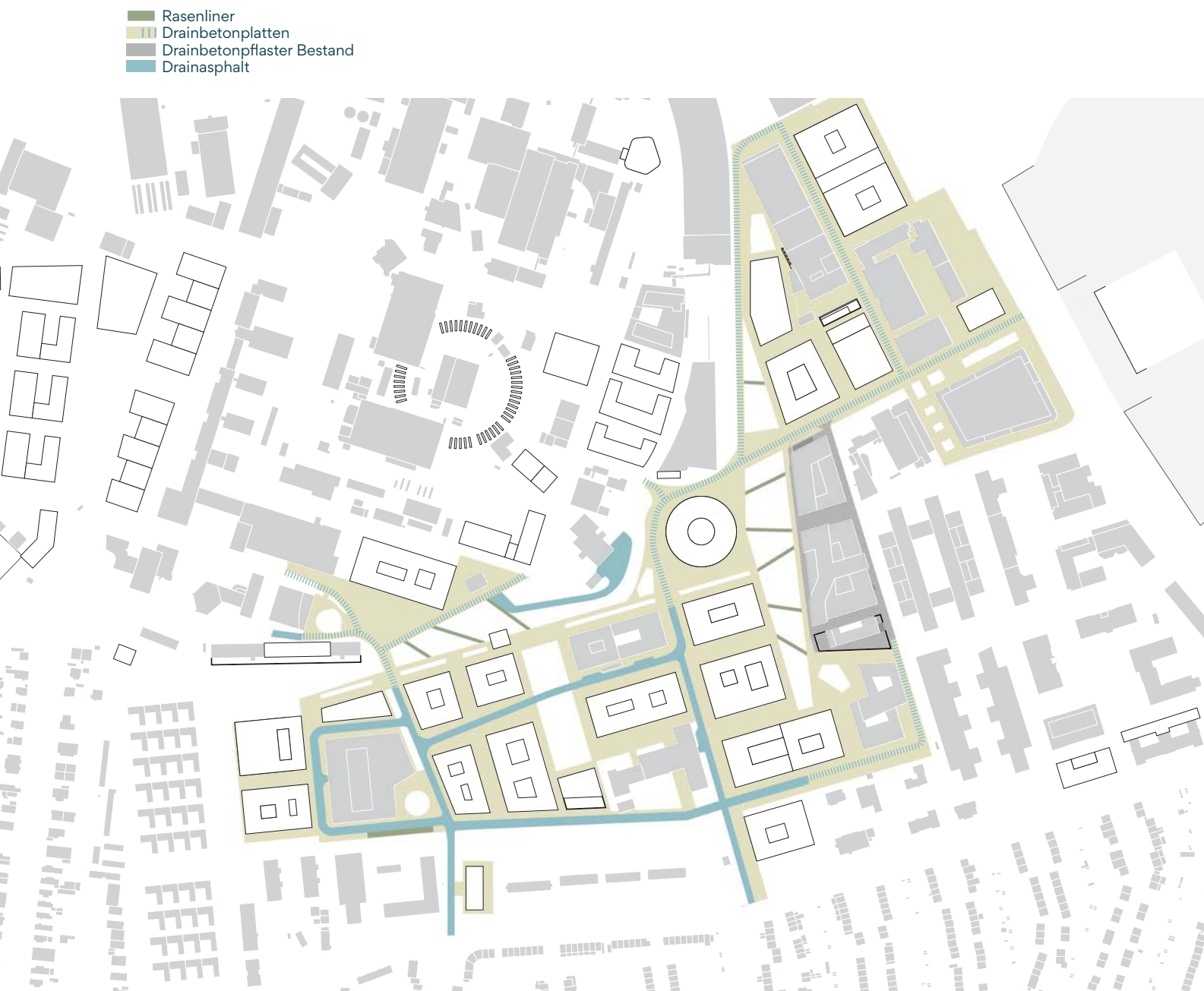
Abb. 16: Regel: Oberflächenmaterialität – Ausschnitt bauliche Struktur, o. M.
