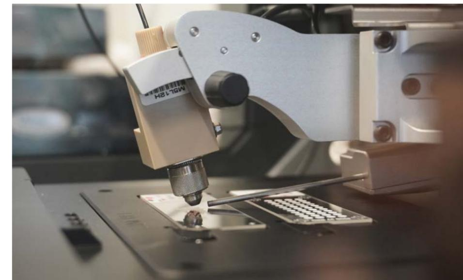
Abb. rechts: Bildgebende Massenspektrometrie eines Gewebeschnittes: Ein sehr feines geladenes Spray wird auf einzelne Probenpixel aufgetragen. Die so aus der Probe rausgelösten geladenen Moleküle werden ins Massenspektrometer geleitet und analysiert (Desorptions-Elektrospray-Ionisation, DESI). © Fraunhofer ITMP
